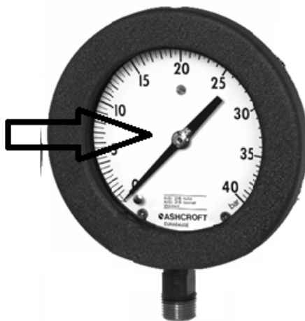
Рисунок 2 - Обозначение места нанесения знака поверки на манометры
